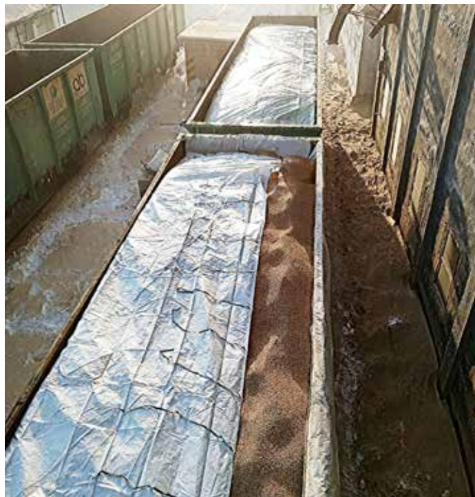
Перевозка зерна в полувагонах насытью с использованием защитных вкладышей. Такой способ облегчает и ускоряет погрузо-разгрузочные работы
